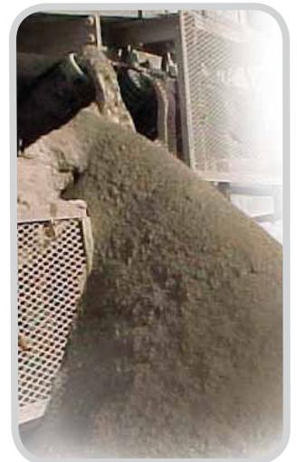
装载区溢出会导致产品损失，输送机部件出现故障，生产停工以及增加清洁成本。
